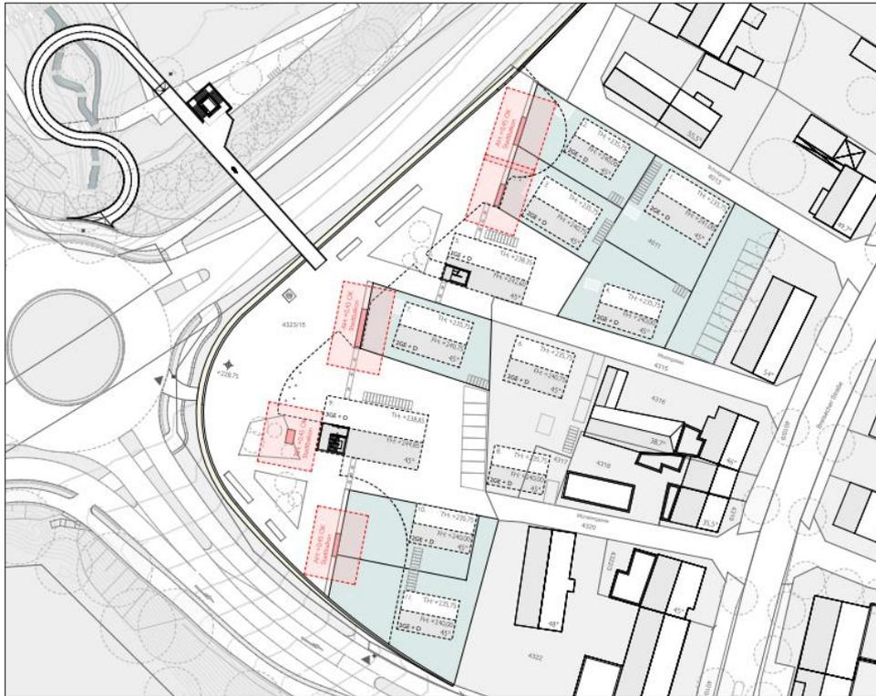
Abbildung 3-3: Lüftungsöffnungen des Parkhauses (rot) und geplante Bebauung des Stadtbalkons (gestrichelt).
